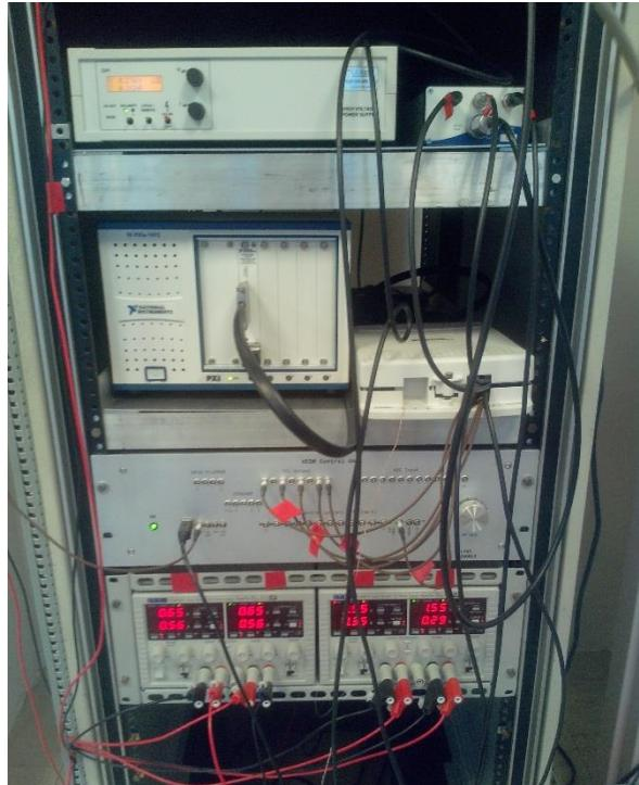
**But du banc de tests:** Mesurer le signal de précession du Hg gazeux dans un champ magnétique contrôlé.
