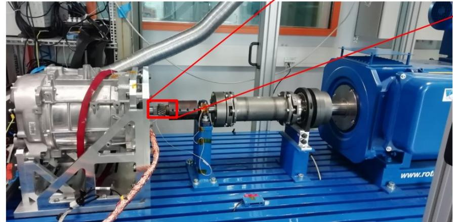
FIGURES 38 & 39 – Photographies du banc ainsi que de la pièce cannelée
