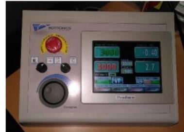
Console de pilotage du banc
