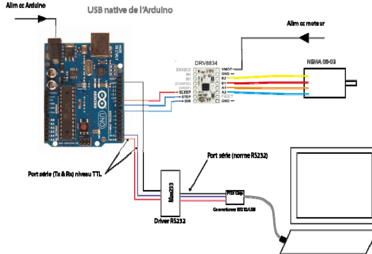
Une autre manière d'atteindre le port série de l'Arduino...par les entrées/sorties logiques Rx et Tx (attention car niveau TTL)
