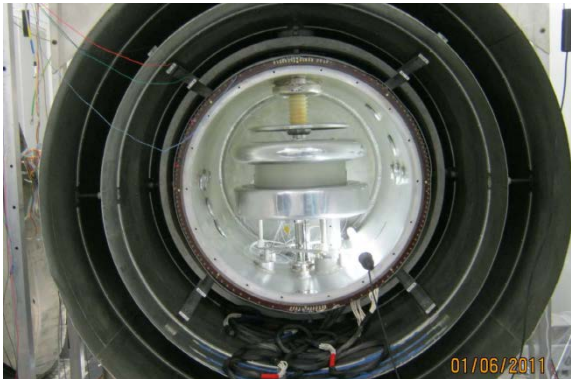
Chambre de précession au centre du blindage magnétique
