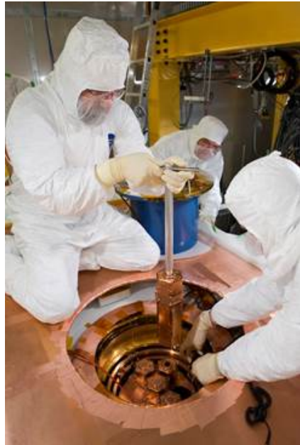
Détecteurs SuperCDMS à Soudan (USA)
