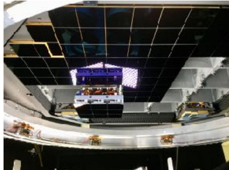
Installation du neuvième module de 9 CCD dans la caméra du LSST. Crédit : LSST camera project
