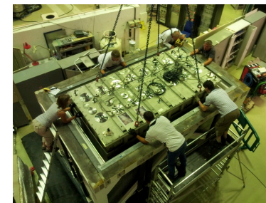
Insertion du détecteur interne dans ses blindages
