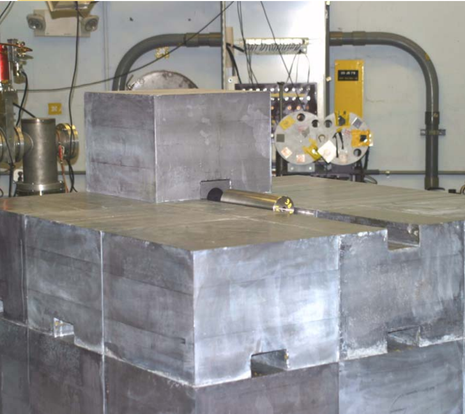
LSDS en cours de montage avec la cible de tungstène
