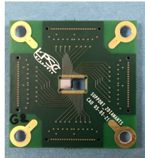
Le détecteur IDSYNCHRO : matrice diamant 1D + QDC + ACQ : 32 voies prototype 1 – Juillet 2021
