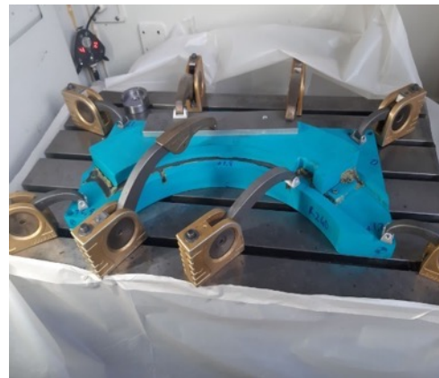
LAB 973 : pièce directement usinée avec le moule
