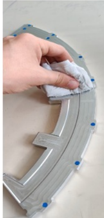
3. Nettoyage, Bouche pore, Démoulant
