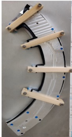
5. Maintien en position du sandwich multicouches
