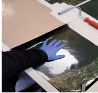
2. Préparation: 24 couches prepreg d'ep. 0,11 mm opération longue et délicate
