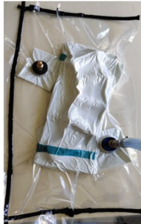
6. Mise en sac sous vide puis cuisson autoclave
